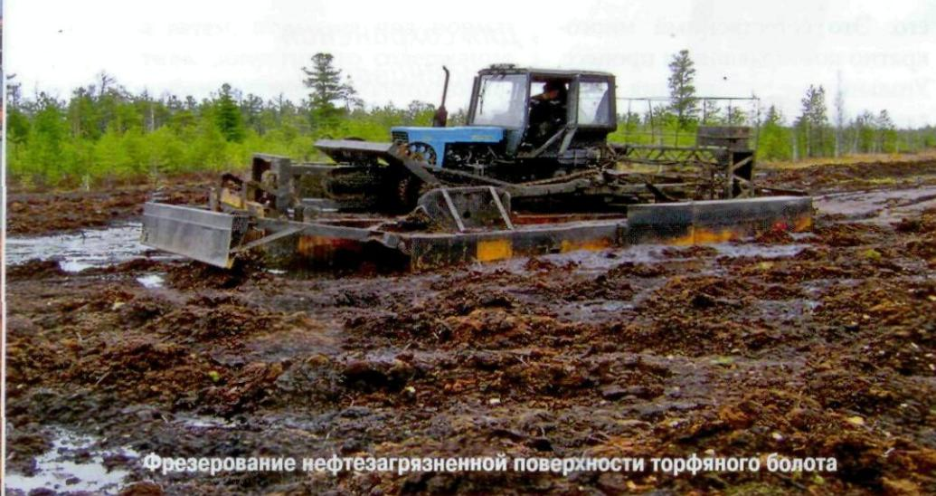
Фрезерование нефтезагрязненной поверхности торфяного болота
